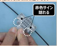
望側の光ケーブルを引っ張り、キャップを引き出します。 キャップが引き出されて作業が完了です。
